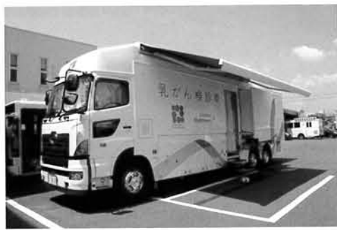
検診時は側壁が65cm拡張し、2台目の超音波検査室となる。
